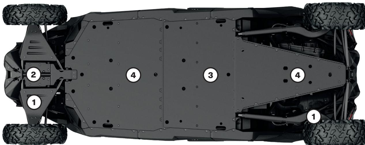
Unser Kunststoff-Unterbodenschutz gleitet ruckfrei und leise über Hindernisse und bietet dabei großartigen Schutz in rauem Gelände. Aus verschleißbeständigem, thermogeforntem hochmolekularem Polyethylen (PE-HMW) mit einer Dicke von 10 mm.
